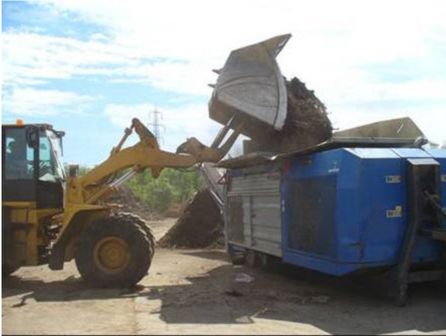
FASE 1. Introduzione nel trituratore della biomassa
