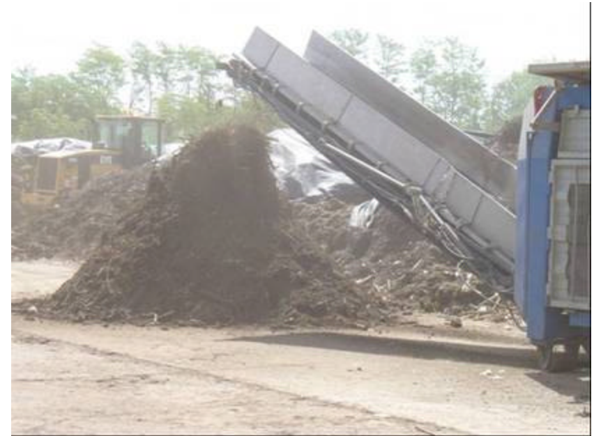
FASE 2. Triturazione e omogeneizzazione della biomassa
